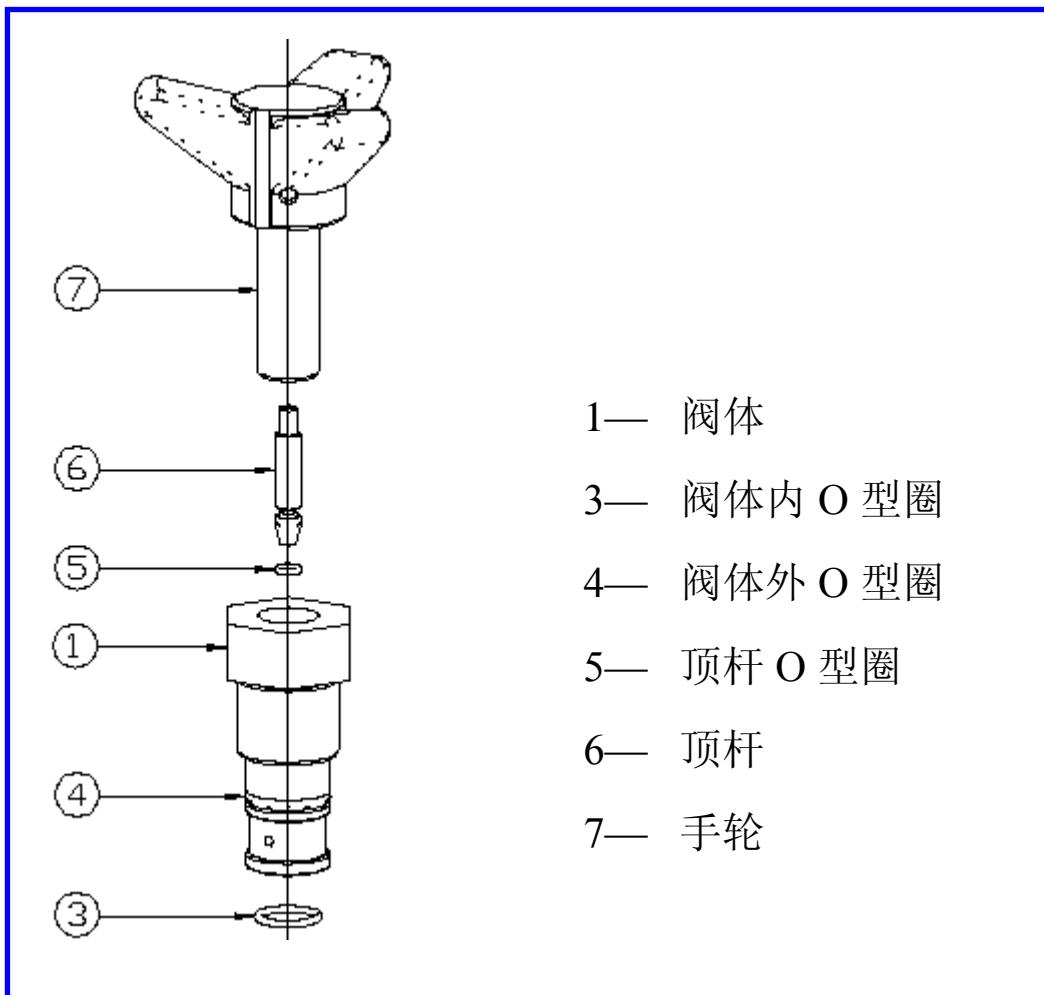
标准的均质阀组是一套均质阀安装在不锈钢阀体内，通过转动手轮，推动顶杆进行均质压力调节。
