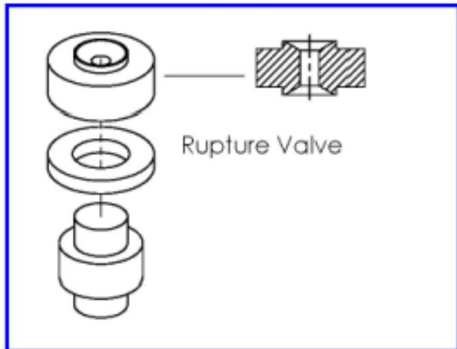
AH-PILOT2015 均质机提供一套R型(破碎)均质阀：由一只撞击头，一只不锈钢的碰撞环和一只碳化钨的阀座组成。阀座采用双面设计，两面均可使用，使用延长一倍。
