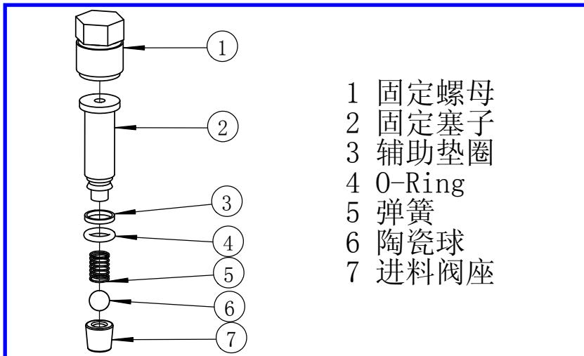
压力块采用高等级双相合金不锈钢制造，确保在高的操作压力下的良好的抵抗应力疲劳，容易拆卸和安装的设计。
