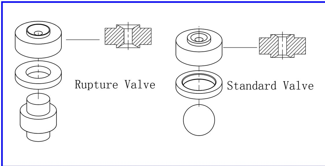
AH100D 均质机提供两套均质阀：一套破碎阀，一套乳化阀。可以安装在一级均质阀体内，也可以装在二级均质阀体内。
