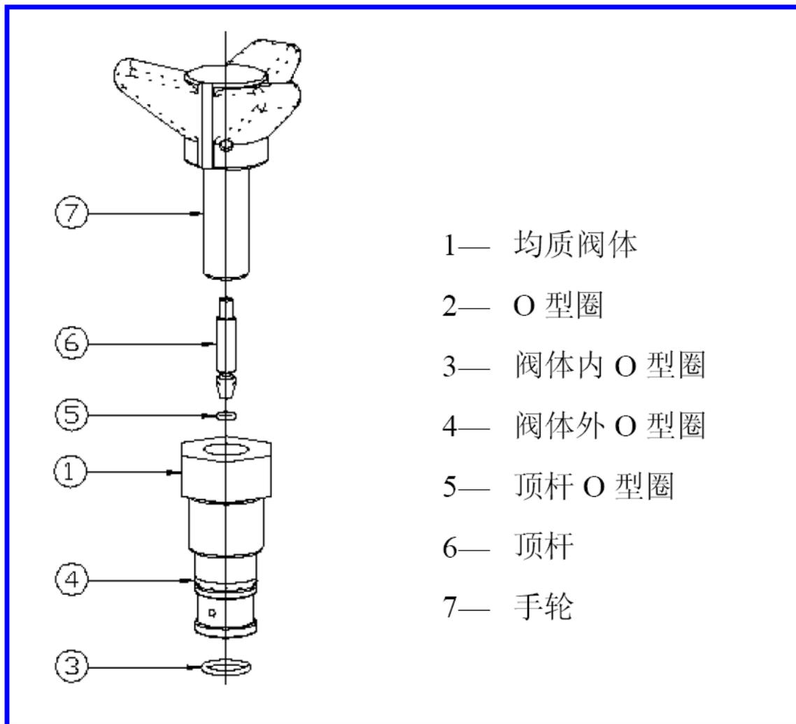
标准的均质阀组是一套均质阀安装在不锈钢阀体内，通过转动手轮，推动顶杆进行均质压力调节。
